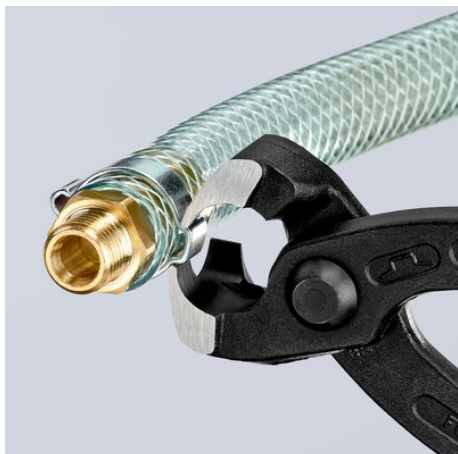
Utěsnění pneumatické hadice na rychlospojce
