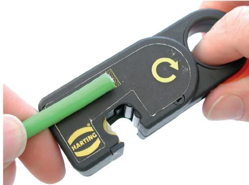
3. Abgemessenes Kabelende in das Werkzeug einlegen und mit dem orangefarbenen Hebel bis zum Anschlag festspannen.
