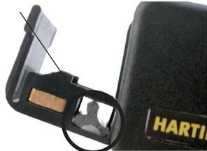
Zur Entnahme Verschlussklappe öffnen, Adapter heraus schieben und entsprechend Bild unten im Schneidwerkzeug montieren.
